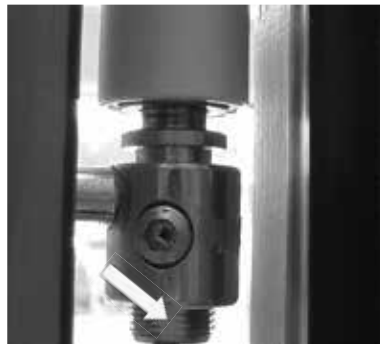
Beim Fixieren muss stets auf der abgefrästen Fläche des Höhentellers geklemmt werden!
