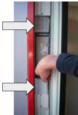
Filtermatten darüber setzen und Abdeckung wieder montieren.
